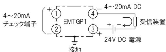
伝送出力図(圧力-出力信号)
