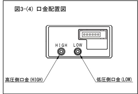
**注意**      ゼロセンタ(+ー)レンジの計器でゲージ圧を計測する場合、表示符号(+、-)と実際の配管内圧力の極性を合わせるため、配管は高圧側口金HIGHに接続してください。
